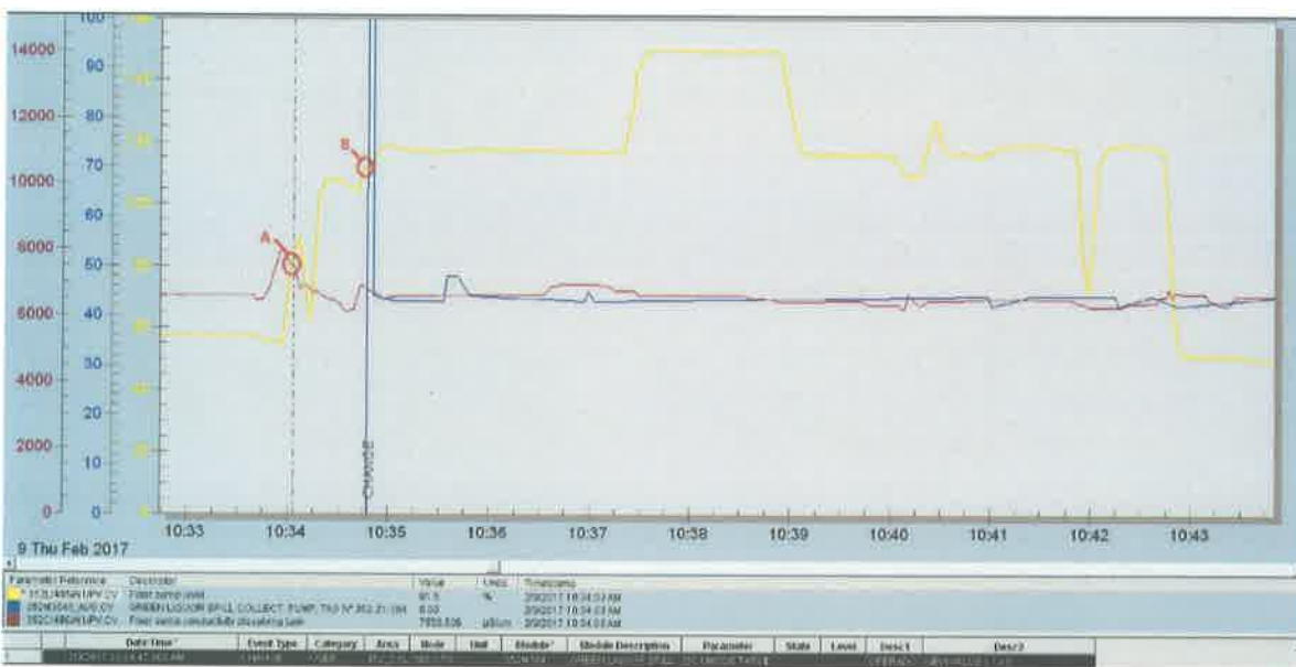
Gráfico 1: Tendencias del nivel del Foso N°4, bomba 352M304 y conductividad CI486 durante la inspección
