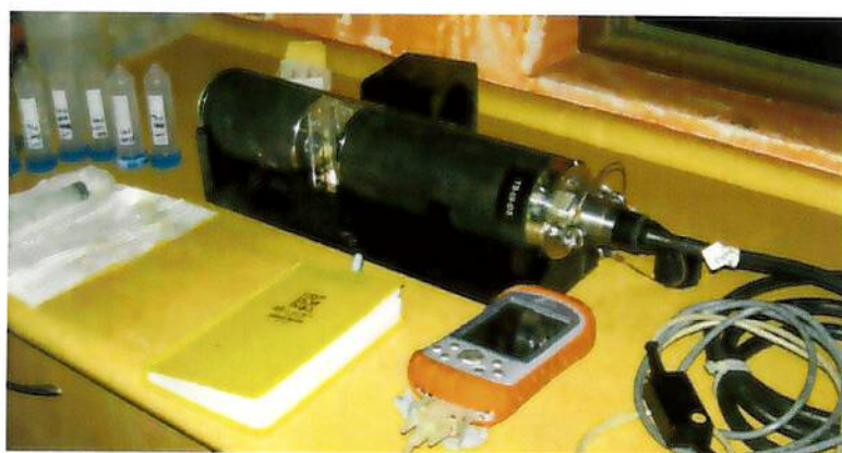
Figura 4.14. Medición de muestras mediante Espectrofluorómetro Fluoroprobe BBE.
