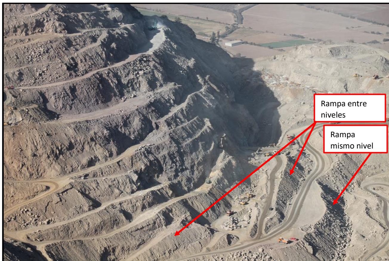
Fotografía N°1. Muestra sectores con rampas realizadas con material estéril.
