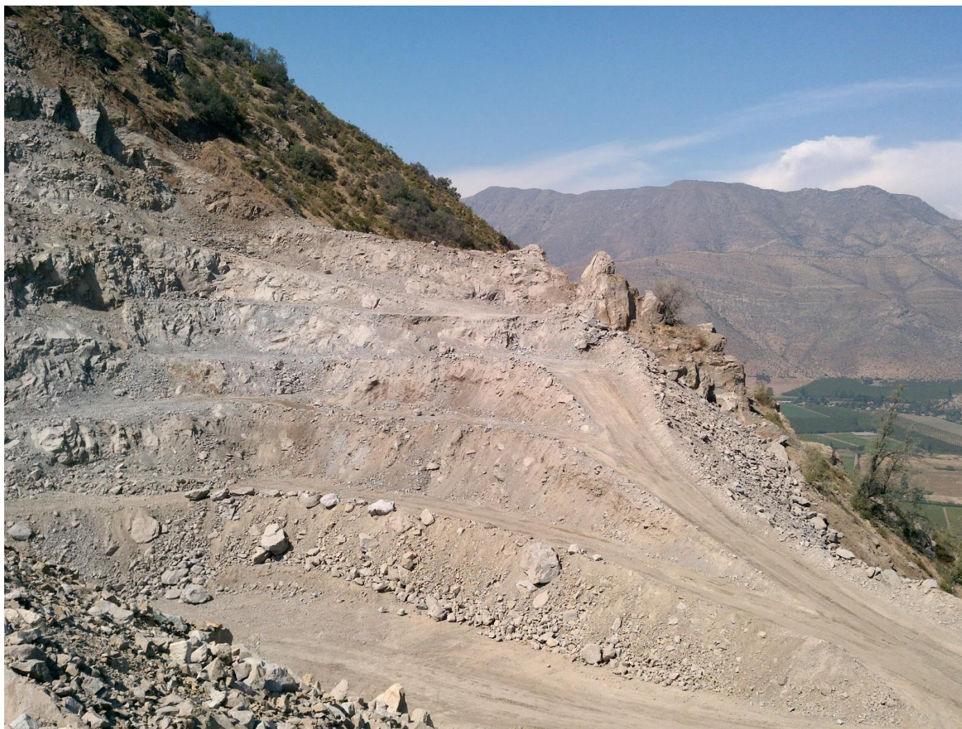
Fotografía N°A3: Rampas construidas con material Estéril
