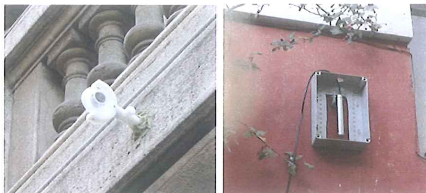
Figura 7. Monitoreo de edificios. Dispositivo típico de monitoreo topográfico (izq.) y sistema electromecánico para medir inclinaciones de fachadas (der.)
