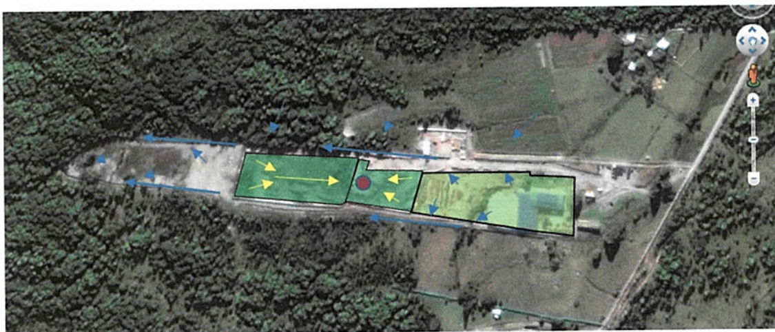
Figura 1. Esquema de la instalación condición actual y sus áreas aportantes. En verde oscuro se destaca área sucia del taller, sector donde se encuentra el sistema de tratamientos de RILes. Las flechas amarillas indican el sentido de escurrimiento de aguas de contacto que caen sobre el taller, las cuales se dirigen al sistema de tratamiento de RILes representado por un punto rojo. En verde claro áreas limpias del taller. Las flechas en azul indican, de manera referencial, el sentido de escurrimiento de las ALL que caen sobre el taller.
