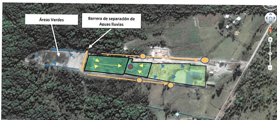
Figura 2. Esquema de la instalación con la condición futura y sus áreas aportantes. En verde oscuro se destaca área sucia del taller, sector donde se elevará pretil existente para delimitar mejor el área sucia. En naranjo se indican zonas donde se realizarán canalizaciones de aguas lluvias con cambio de pendientes hacia pozos de infiltración, señalados en círculos naranjos. La zona trasera del taller se mantendrá como área verde, por ende continuará con las pendientes que actualmente poseen.
