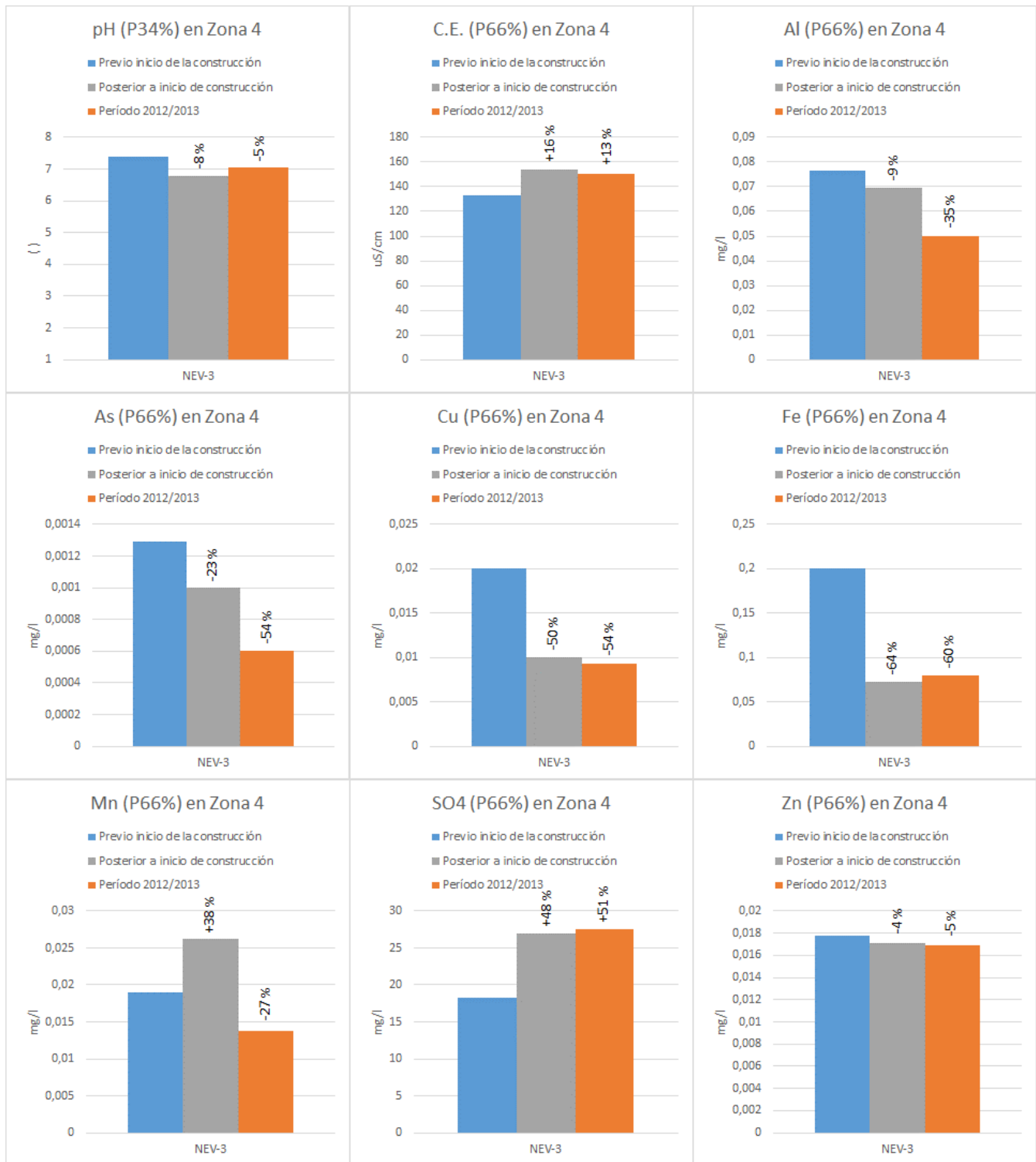
Figura 18. P66 (o P34 para el pH) en los pozos de la Zona 4 distinguiendo entre el período pre-construcción, el período post-construcción y el período 2012/2013. Se indica la variación porcentual de los dos últimos respecto del primero (Fuente: elaboración propia en base a fuentes de información detalladas en el numeral 5 del presente Anexo).
