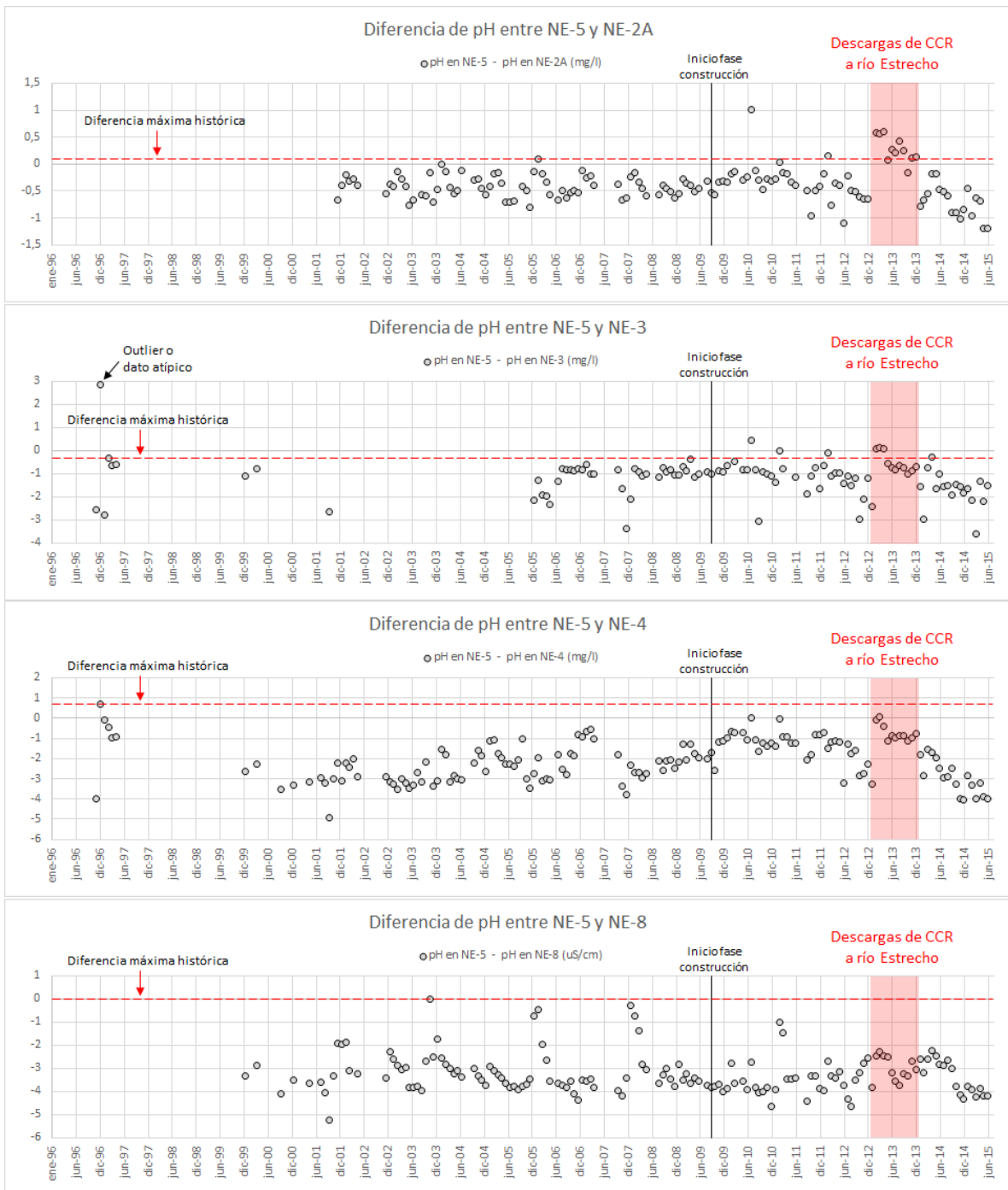
Figura 26. Diferencia entre el pH medido en NE-5 y el medido en NE-3, NE-4 y NE-8 (Fuente: elaboración propia en base a datos de seguimiento ambiental reportados).
