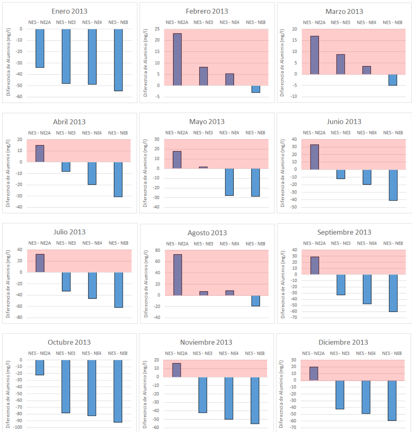
Figura 6. Estado mensual (año 2013) de la diferencia de Aluminio entre NE-5 y las demás estaciones DAR, comparado con la respectiva diferencia mínima histórica (Fuente: elaboración propia en base a datos de seguimiento ambiental reportados).
