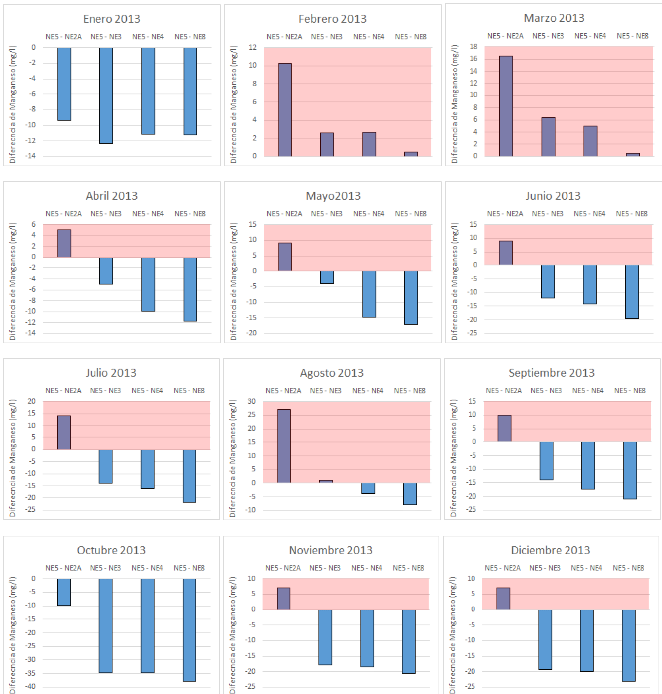
Figura 14. Estado mensual (año 2013) de la diferencia de Manganeso entre NE-5 y las demás estaciones DAR, comparado con la respectiva diferencia mínima histórica (Fuente: elaboración propia en base a datos de seguimiento ambiental reportados).
