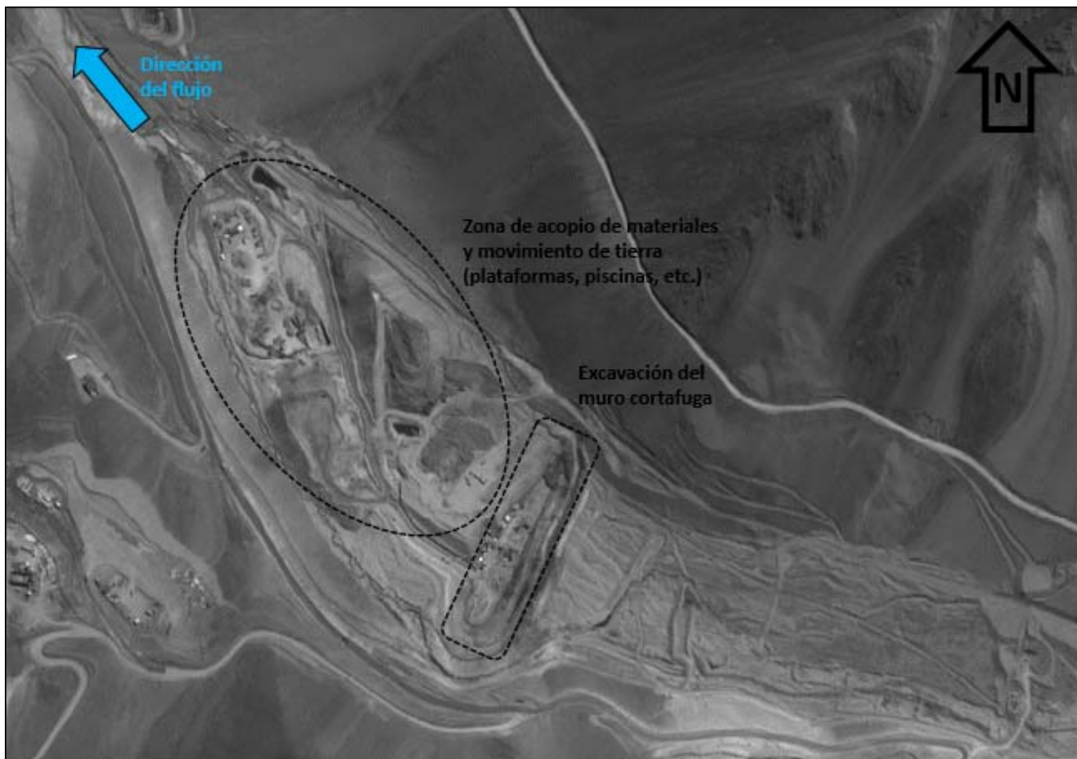
Figura 5. Intervención del cauce del río Estrecho durante la construcción del muro cortafuga (Imagen remitida por CMNSpA en su Carta PL-036/2017, de fecha 3 de abril de 2017, en respuesta a la solicitud emanada de la Res. Ext. D.S.C./P.S.A. N°199, del 20 de marzo de 2017).
