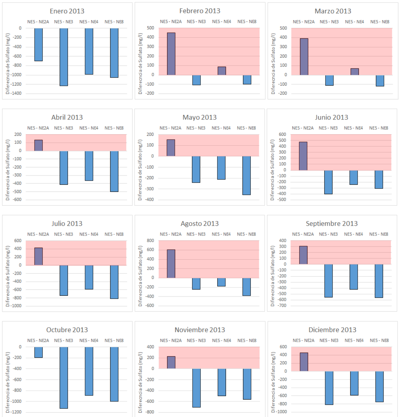
Figura 16. Estado mensual (año 2013) de la diferencia de Sulfato entre NE-5 y las demás estaciones DAR, comparado con la respectiva diferencia mínima histórica (Fuente: elaboración propia en base a datos de seguimiento ambiental reportados).
