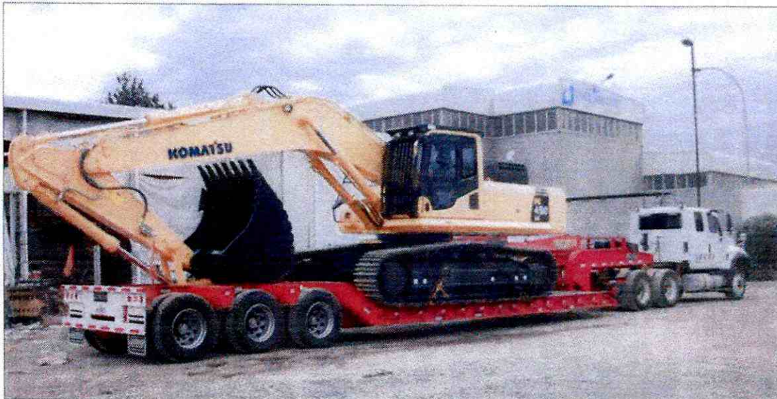
Fotografía 7-2: Camión cama baja
