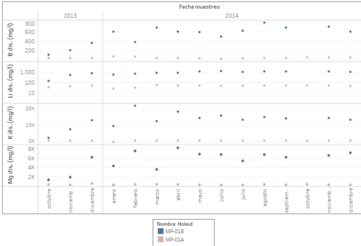
Figura 6-14: Evolución temporal del B, Li, K y Mg disueltos en los piezómetros MP-01A y MP-01B situados en el sureste de la zona Marginal.
