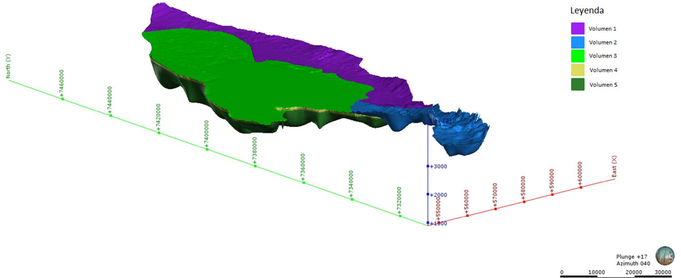
Figura 5-22: Vista noreste de los acuíferos del Salar de Atacama construídos en el Leapfrog Hidro V2.7.2. Exageración vertical: x8.
