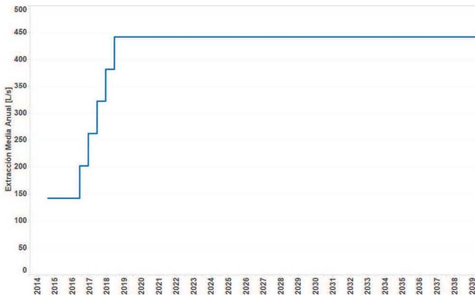
Figura 1-2: Regla operacional de Rockwood Lithium aprobada en RCA 021/2016.
