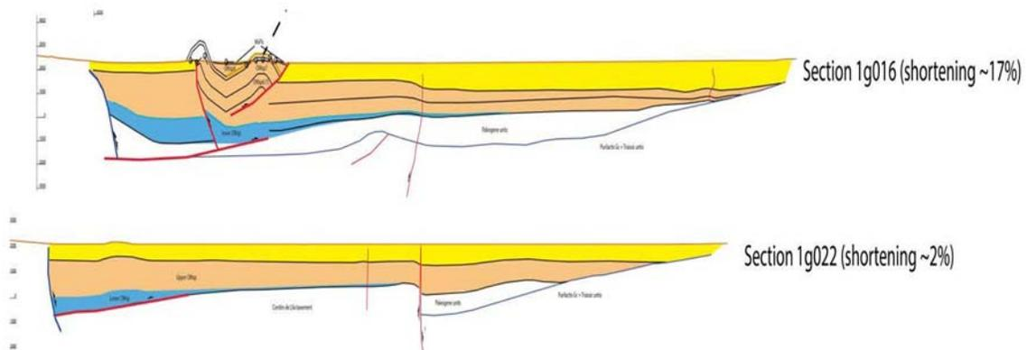
Figura 5-11: Perfiles geológicos realizados a partir de la interpretación de los perfiles sísmicos. Ubicación de los perfiles en Figura 5-10.
