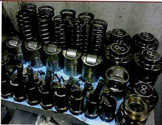
Mantenimiento Bombas Inyectoras
