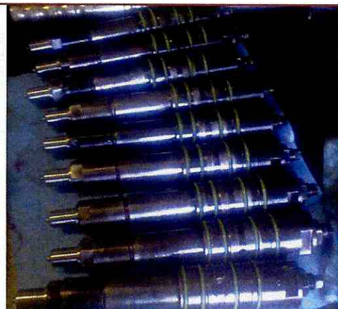
Armado y Calibración de Inyectores
