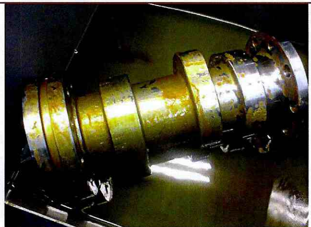
Cambio de Tramo de Leva con Desgaste
