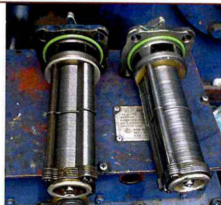
Mantenimiento Filtros de Aceite
