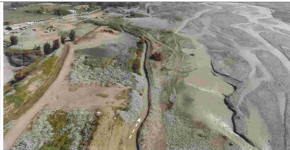
Imagen 4: canal que dirige las aguas del río Cachapoal hacia el interior de la planta
