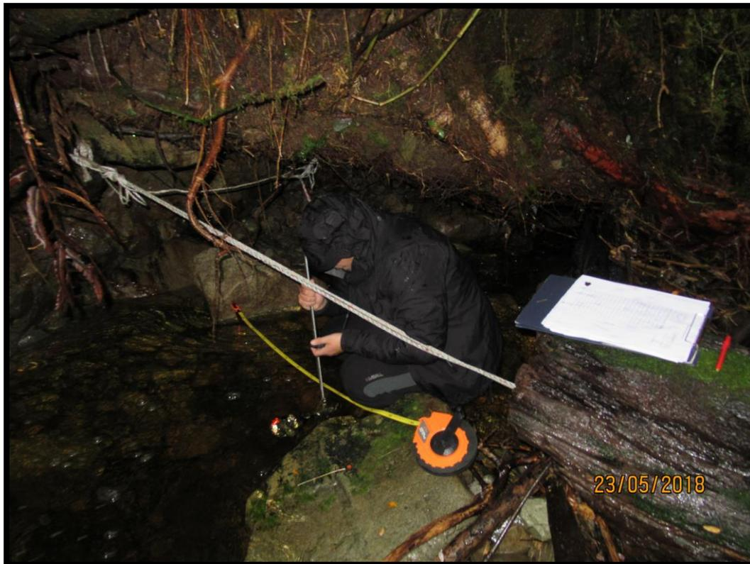
En esta imagen se puede apreciar como en una sección transversal del cauce del estero, dividida con una huincha de distancia se toman mediciones de flujo de agua que escurre por cada sección.
