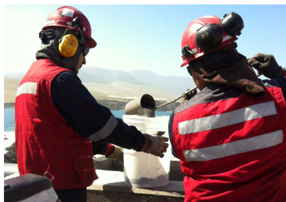
Figura 10. Muestreo con pala cilíndrica
