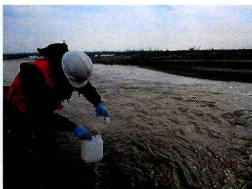
Fotografía 9: Toma de muestras para análisis de calidad del agua del río Cachapoal.
