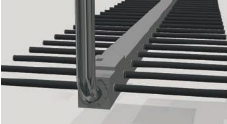
Figura N° 2. Esquema del sistema de aireación
