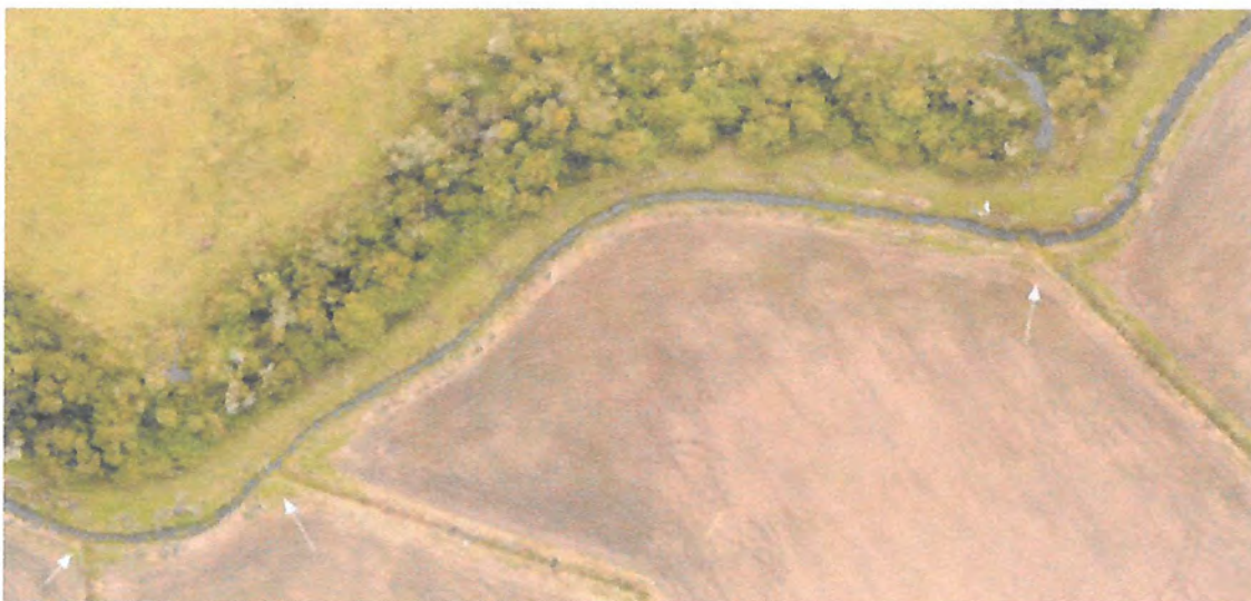
Figura 6: Sistemas de drenes asociados al estero Yutreco (5.509.871 N y 673.987 E, WGS84 H18)
