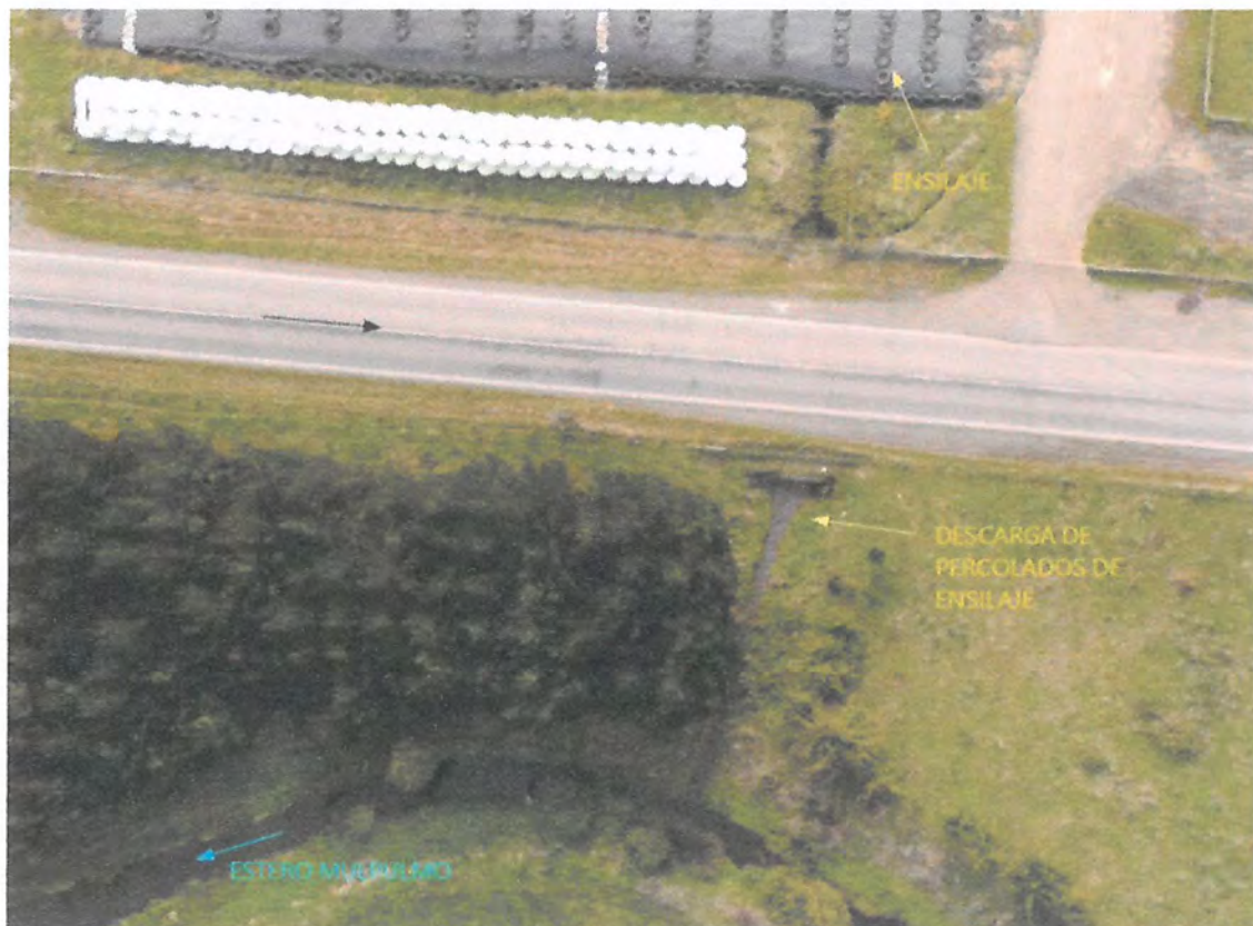
Figura 11: Detalle del aporte de percolados por ensilaje al Estero Mulpulmo, aguas abajo [E4] (5.508.774 N y 673.764 E, WGS84 H18)
