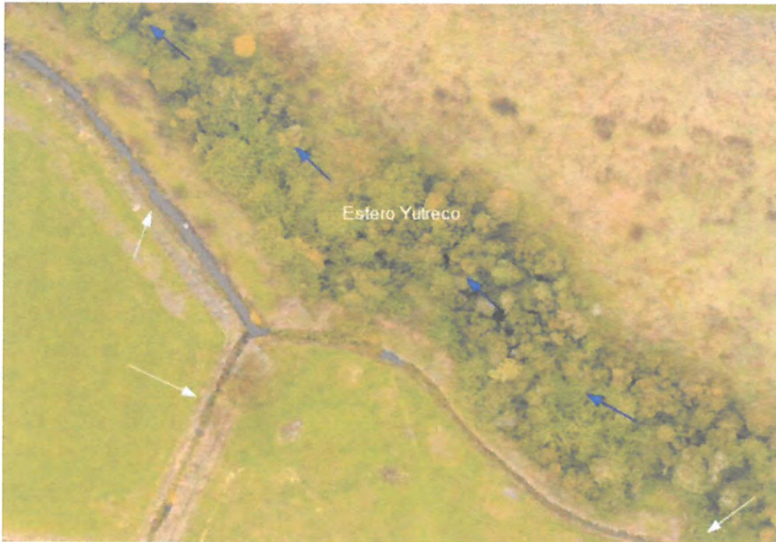
Figura 16: Extracción de agua desde el estero Yutreco a canal colector de drenaje predial. (5.509.377 N y 674.539 E, WGS84 H18)
