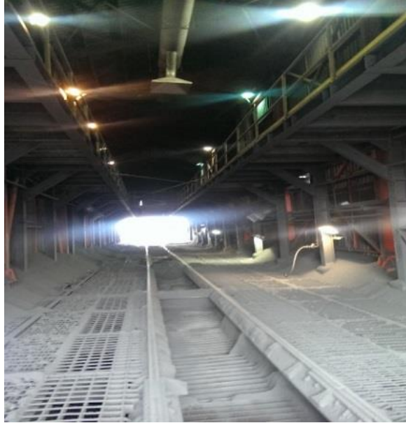
Figura 5-33: Inexistencia de sistema de encapsulamiento tipo campana.
