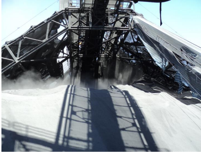
Figura 5-144: Caída de preconcentrado seco desde corre N° 2719.
