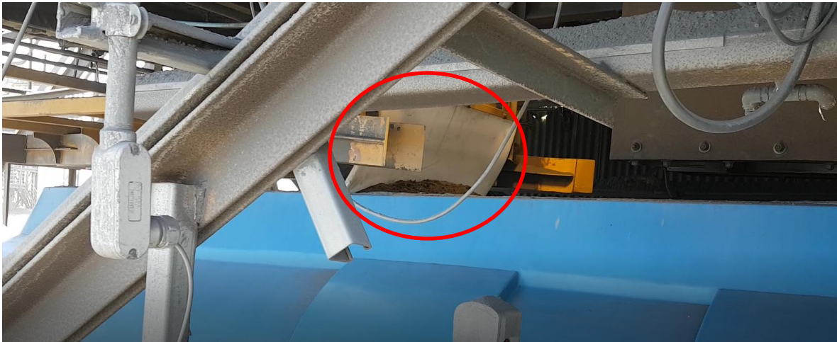
Figura N°4, Ejecución del rasado de carga en tolvas de trenes.
