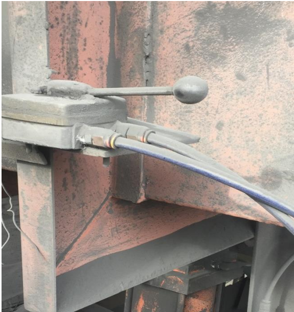
Figura N°1, manilla de accionamiento subir o bajar enrasador.
