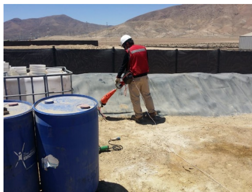
FOTOGRAFIAS DE ENSAYO ARC TESTING BAJO NORMA ASTM D-7953 EN CANCHA DE ACOPIO
