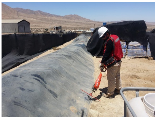
FOTOGRAFIAS DE ENSAYO ARC TESTING BAJO NORMA ASTM D-7953 EN CANCHA DE ACOPIO
