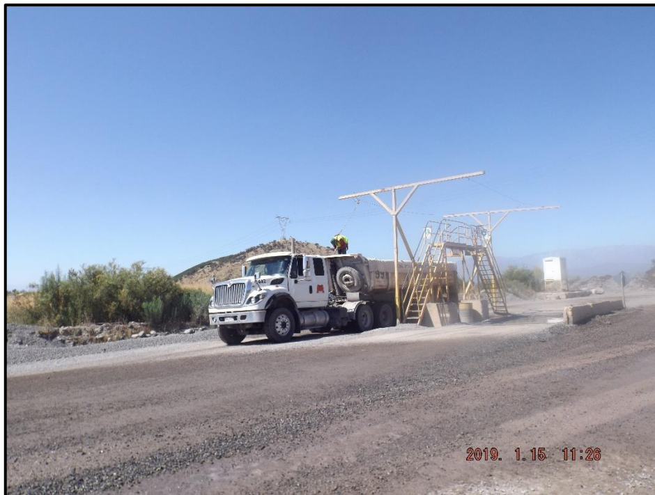
Foto N°3. Registro Fotográfico de Instalación de Encarpado de Tolva de Camiones para el Ingreso como para la Salida de la Planta
