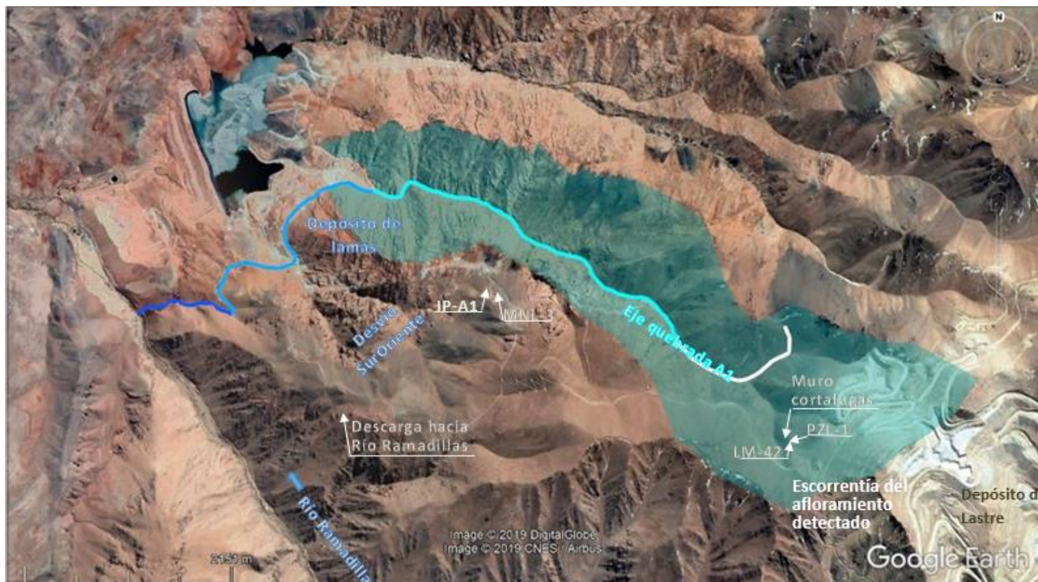
Figura 2-2: Trayectoria estimada de la escorrentía del escurrimiento natural detectado en Fiscalización.
