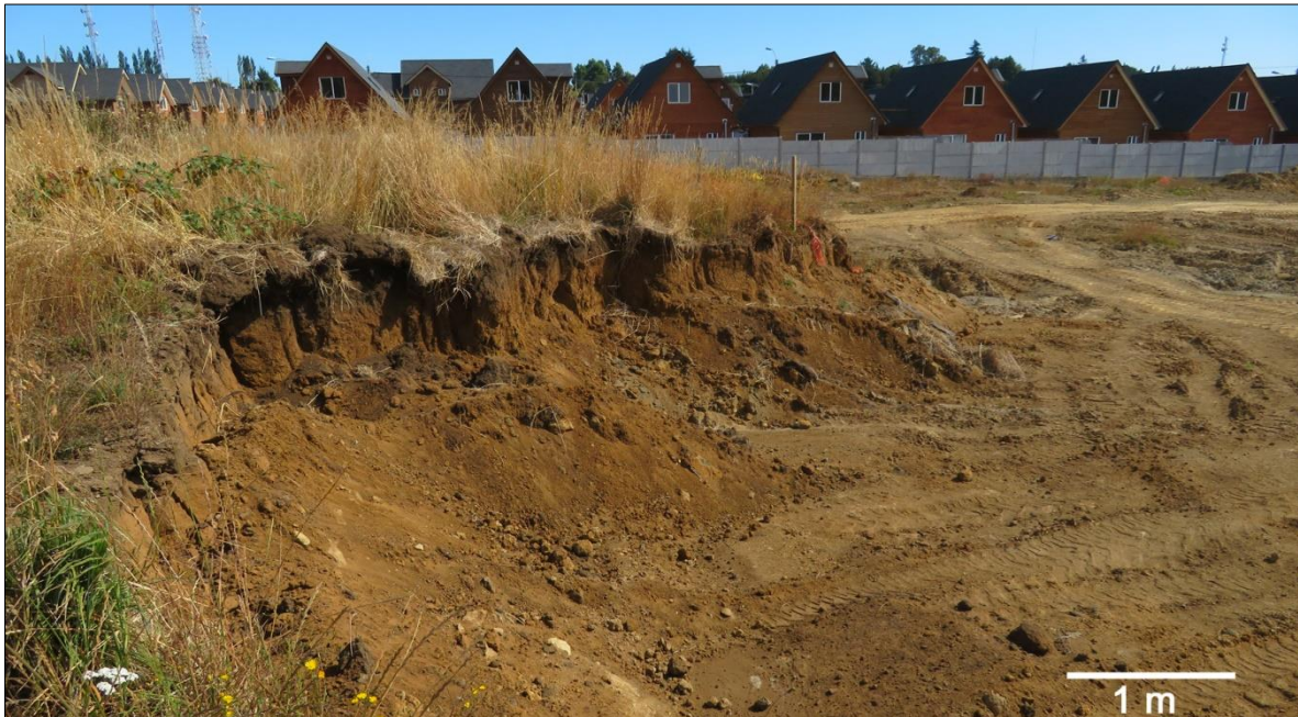
Fotografía 5-2: Punto de control 05. Vista hacia el suroeste. Se observan sedimentos arcillosos (potencia entre 1 y 1,5 m).
