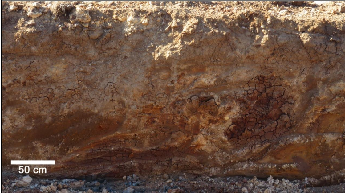
Fotografía 5-4: Punto de control 08. Detalle de los sedimentos arcillosos, estratificados hacia la base.
