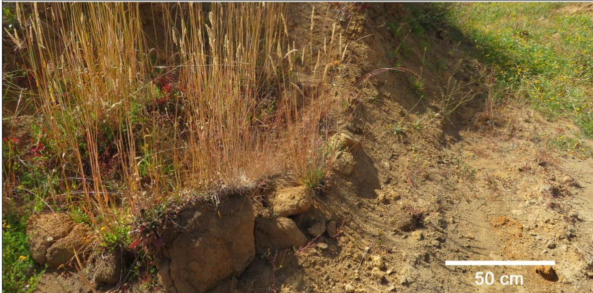
Fotografía 5-2: Punto de control 05. Vista hacia el suroeste. Se observan sedimentos arcillosos (potencia entre 1 y 1,5 m).
