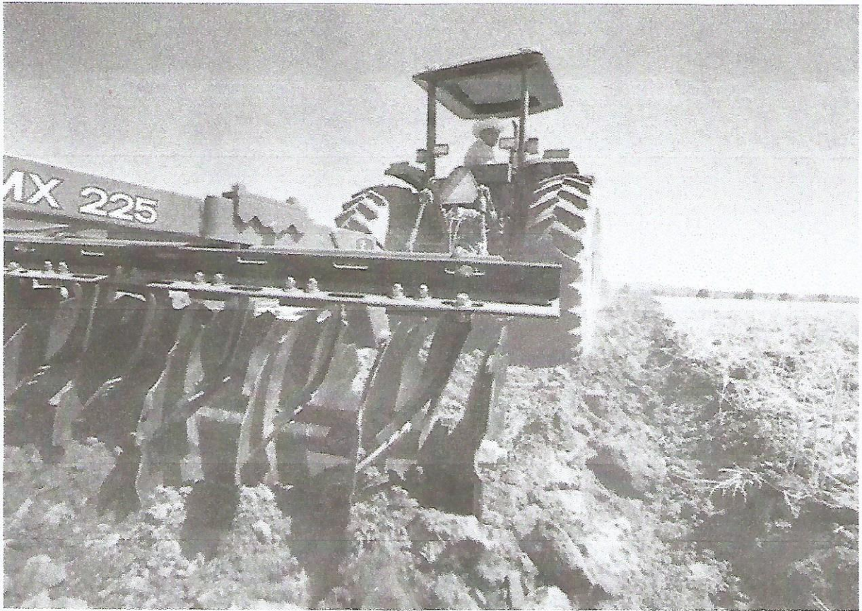
Imagen 8. Foto de tractor con implemento de arado de discos para invertir y preparar así el suelo para la siembra.
