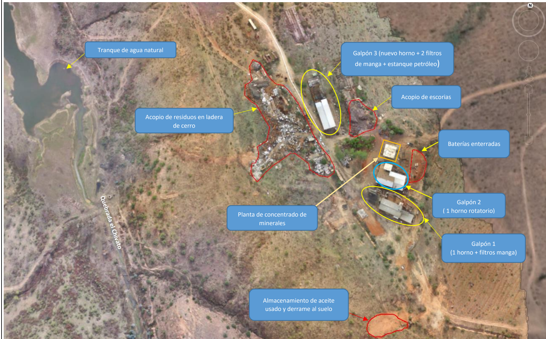
Figura 2. Layout del proyecto (Fuente: foto aérea DRON y herramienta de Google Earth; elaboración propia).
