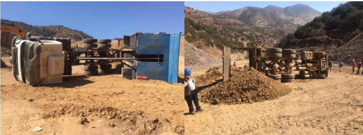
Fotografía 1 y 2 – Volcamiento de Camión Tolva Encargado del Carguío de Residuos.
