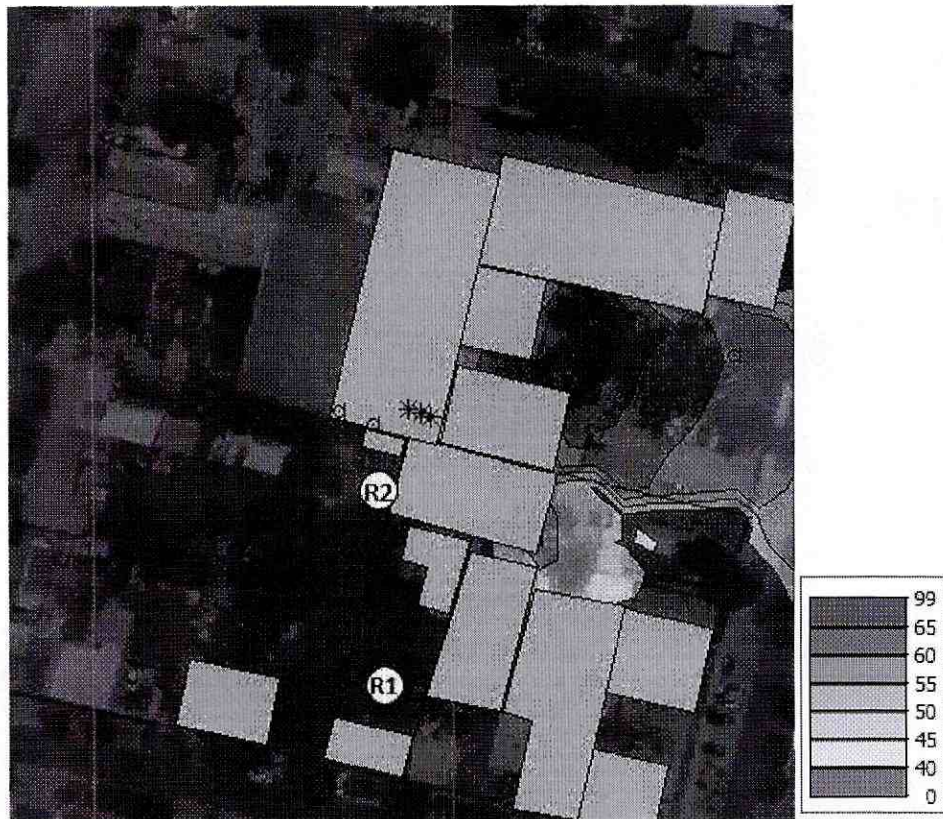
Fig. 13: Mapa de emisión de ruido desde las instalaciones de Marvest hacia los puntos receptores, implementando medidas de control.
