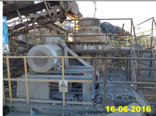
Foto 2 ANTES. Detalle de Chancador de Cono antes de la instalación de la barrera acústica. Fecha: 16-06-2016. Coordenadas UTM: N 6.688.230, E 290.582, H19, DATUM WGS 84.
