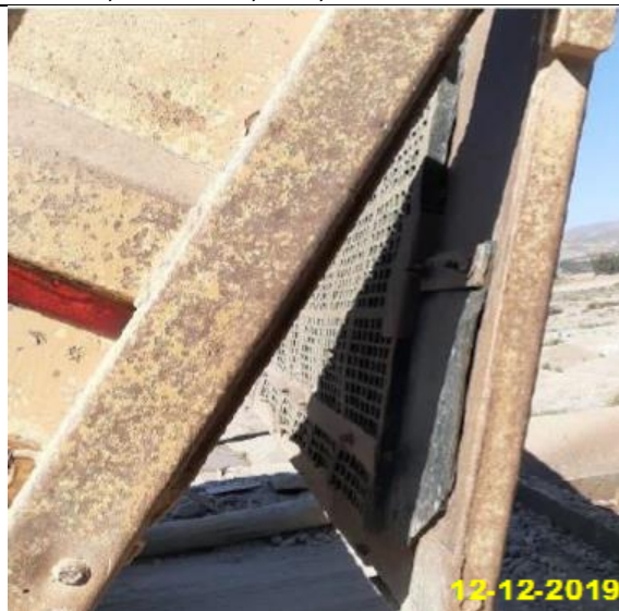
Foto 7 DESPUÉS. Detalle de instalación de la barrera acústica en chancador de mandíbula y descarga de camiones en el buzón principal. Fecha 12-12-2019
