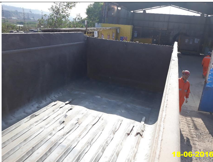
Foto 6 ANTES. Detalle de la situación antes de la instalación de la amortiguación acústica, recubrimiento de goma (poliuretano), vista interna de la tolva normal del camión de transportes de materias primas. Fecha: 18-06-2016.
