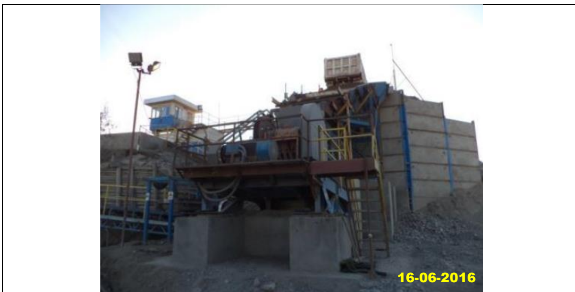
Foto 4 ANTES. Detalle de la situación antes de la instalación de la barrera acústica en chancador de mandíbula y descarga de camiones en el buzón principal. Fecha: 16-06-2016. Coordenadas UTM: N 6.688.230, E 290.582, H19, DATUM WGS 84.
