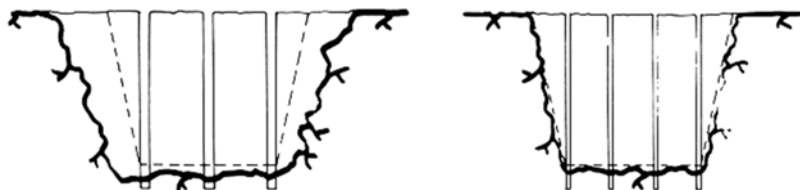
Figura 97: Disposición de barrenos de mayor diámetro (izqda.) y de menor diámetro (drcha.) para una misma voladura en zanja
