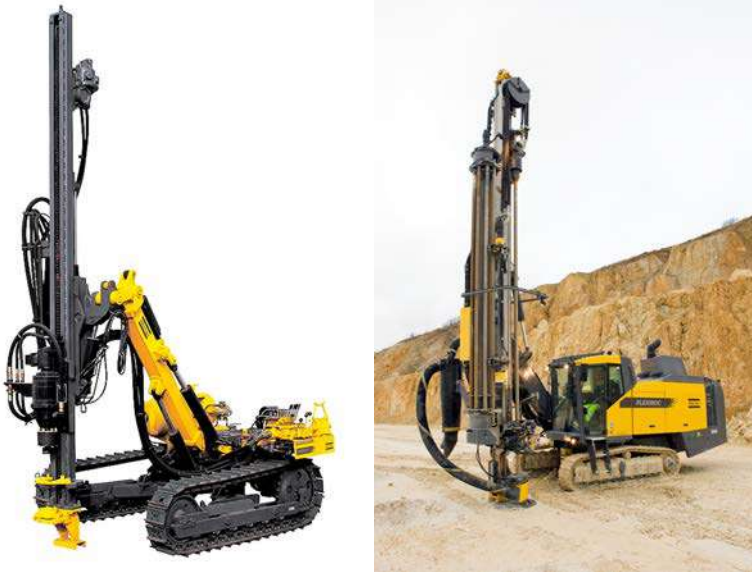
Figura 5: Disposición de equipos de perforación: Con martillo en cabeza (izq) y con martillo en fondo (drcha).
