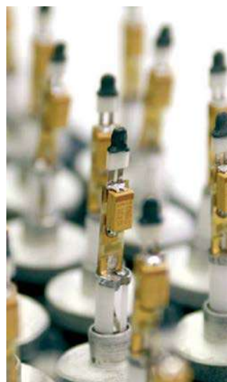
Figura 70: Microchip e inflamador de detonador electrónico (DynaEnergetics)
