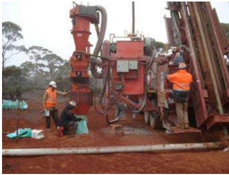
Figura 39: Recogida de detritus del sondeo
