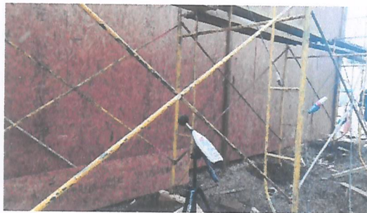
Figura 6. Medición realizada con fuente de ruido al interior del túnel acústico.
