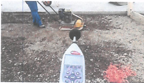
Figura 4. Medición realizada a 2 m de fuente de ruido sin pantalla acústica perimetral.
