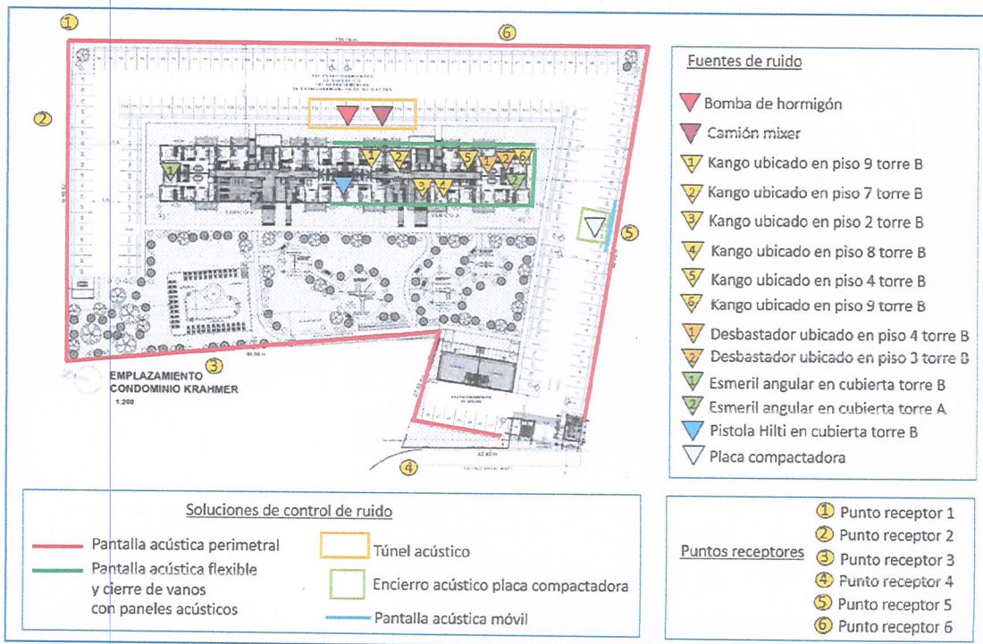
Figura 16. Ubicación de fuentes de ruido, soluciones de control de ruido, y puntos receptores.
