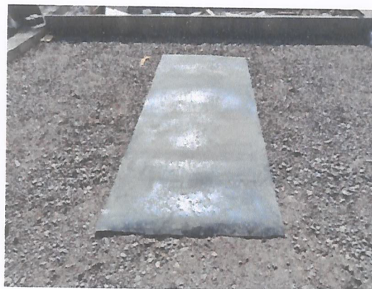
Lámina de caucho para placa compactadora
