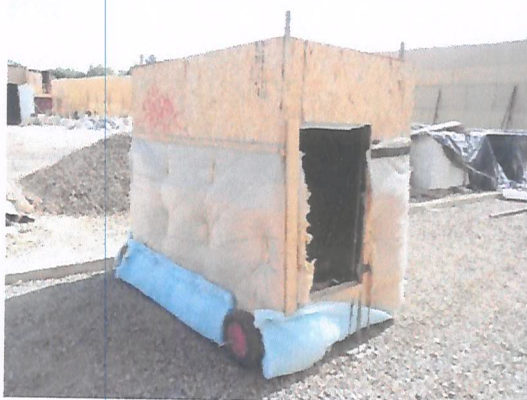
Cierre acústico móvil para placa compactadora
