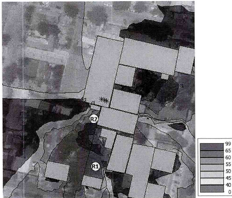
Fig. 12: Mapa de emisión de ruido desde las instalaciones de Marvest hacia los puntos receptores, considerando la situación actual.
