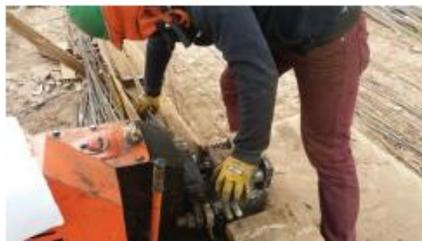
**Foto 14:** Dimensionado de fierros con Cortadora Cizalla eléctrica China.
