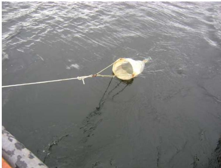
Figura 5. Recolección del fitoplancton con una red estándar de 35 \mu\text{m} de abertura de malla, Arica, agosto 2020.
