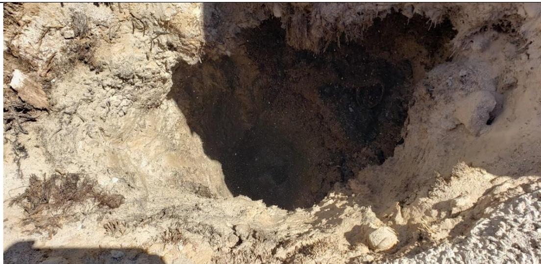
Imágenes de fecha 05/10/2019, en la que se realizó excavación en el bofedal para ver a qué nivel se encuentra el agua, se excavó hasta unos 1.30 metros aproximadamente y no se encontró agua
