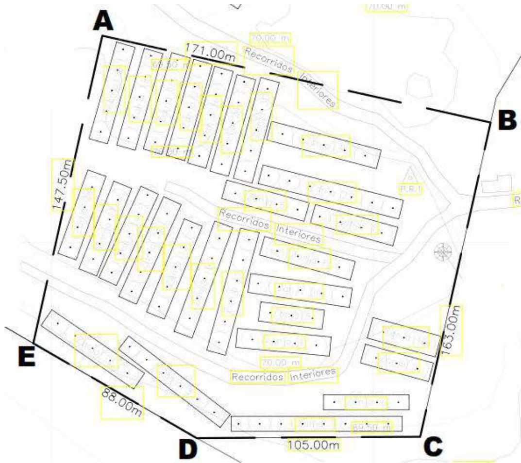
Fig. 14: Distribución de chimeneas en zanjas cerradas dentro de las 3 hectáreas autorizadas.
