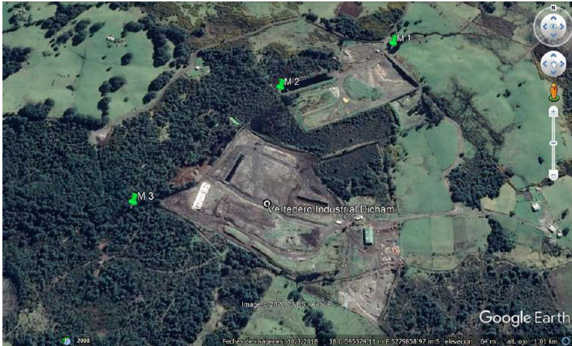
Fig. 2: Estaciones de muestreo de aguas superficiales. M 1: punto de muestro aguas arriba de ambos vertederos. M 2: punto ubicado entre ambos vertederos. M 3: punto aguas abajo por el lado weste de ambos vertederos.
