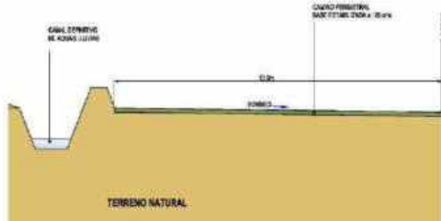
Figura .21. Camino perimetral
