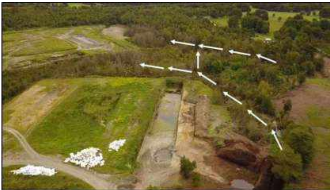
Fig. 22: Trayectoria de los cauces aguas abajo hacia ambas zonas de empozamientos. Fotografía tomada el 20/12/2019.
