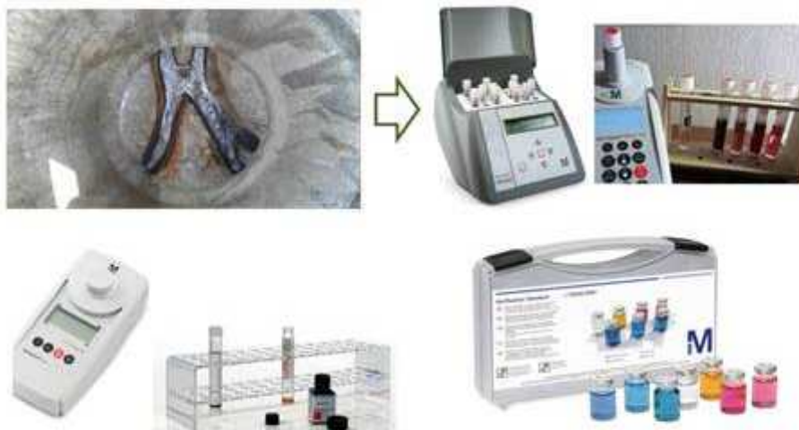
Toma de muestras en punto unico de descarga con equipo y viales de Nitrogeno Total en conjunto con analisis de Nitritos y Nitratos.
