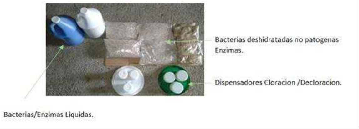
Imagen N°4 – Bateria Productos químicos.
