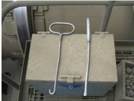
Herramientas utilizadas para extracción de Venturi y canastillo con filtro de mangas.
