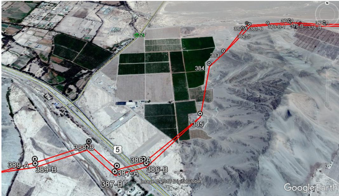
Figura 2: Tramo de la RCA N°102/2016 (Torres 378-A@389-B) donde el escarpe sólo aplica en las fundaciones de las 15 estructuras. La línea roja corresponde al eje de la línea.
