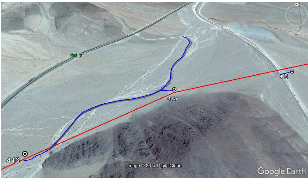
Figura 5: Tramo de la RCA N°114/2015 (Torres 414@416) donde el escarpe aplica en el área de trabajo de la torre y el acceso (peinetas). En rojo el eje de la línea y azul los caminos de acceso.
