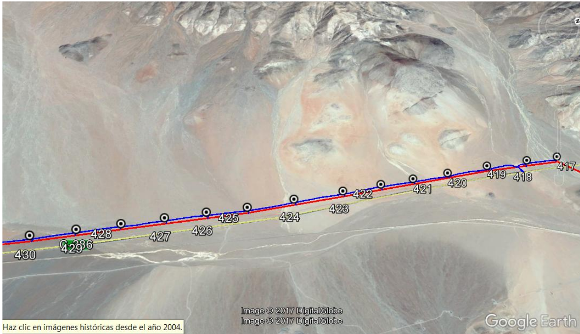
Figura 6: Tramo de la RCA N°114/2015 (Torres 417@430) donde se aplicó el escarpe tanto en el área de trabajo de la torre, el acceso (peineta) y a lo largo del troncal. En amarillo la ruta C-386, en rojo el eje de la línea y en azul los accesos o peinetas y el troncal.
