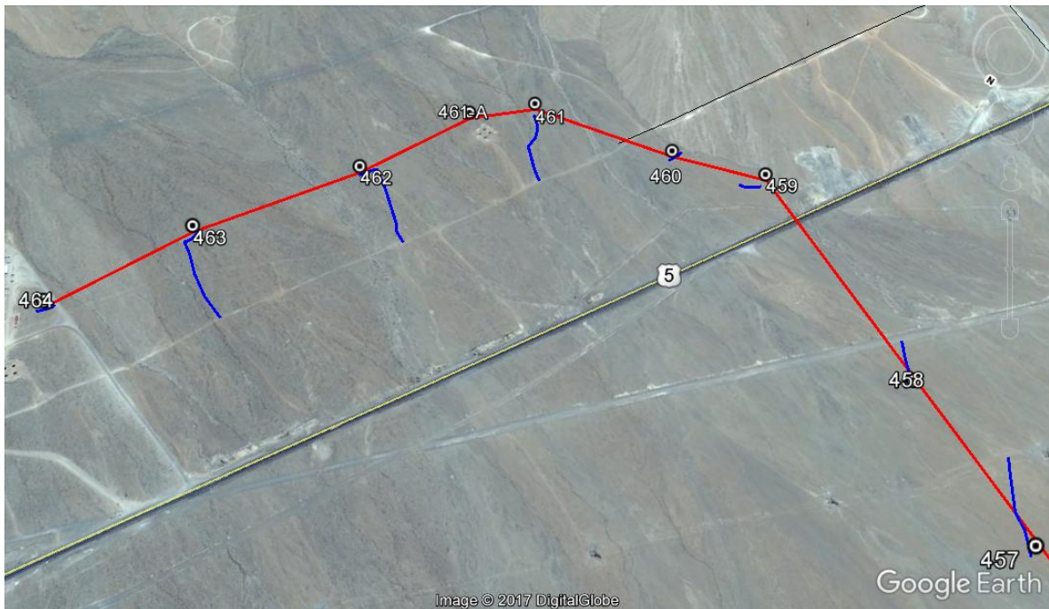
Figura 9: Tramo de la RCA N°114/2015 (Torres 457@464) donde aplica el escarpe tanto en el área de trabajo de la torre como caminos de acceso. En rojo el eje de la línea y en azul los accesos o peinetas.
