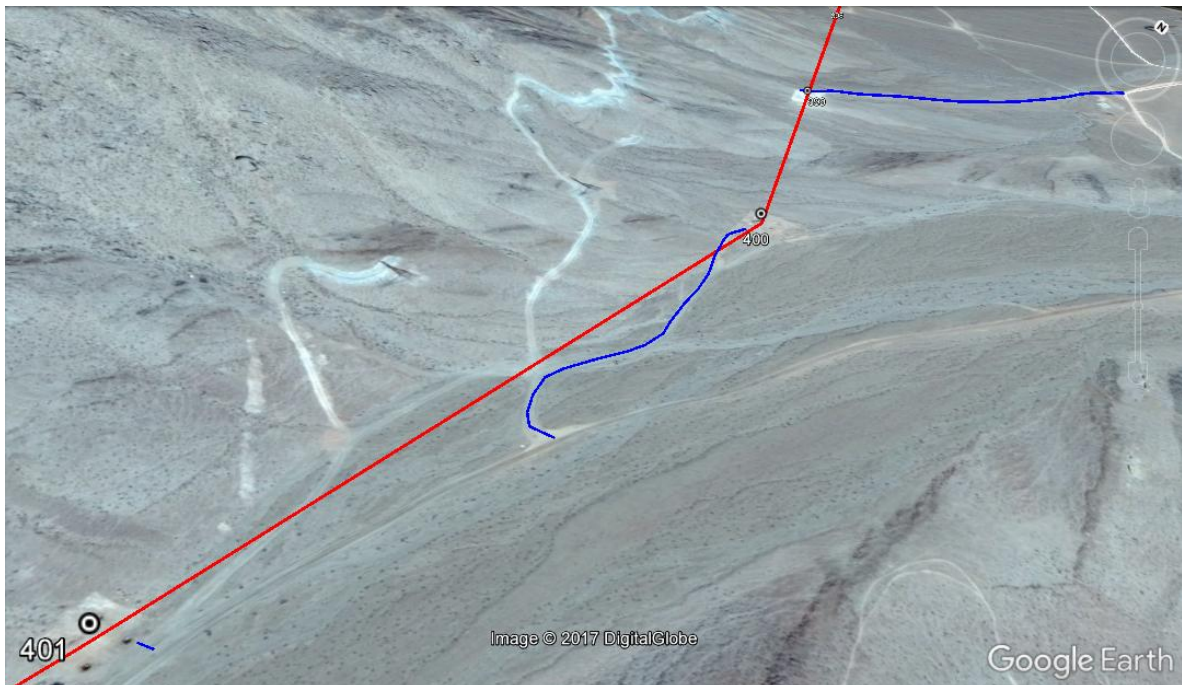
Figura 3: Tramo de la RCA N°504/2012 (Torres 399@401) donde el escarpe aplica en caminos de acceso y el área de trabajo de la torre. En rojo el eje de la línea y azul los caminos de acceso (peinetas).
