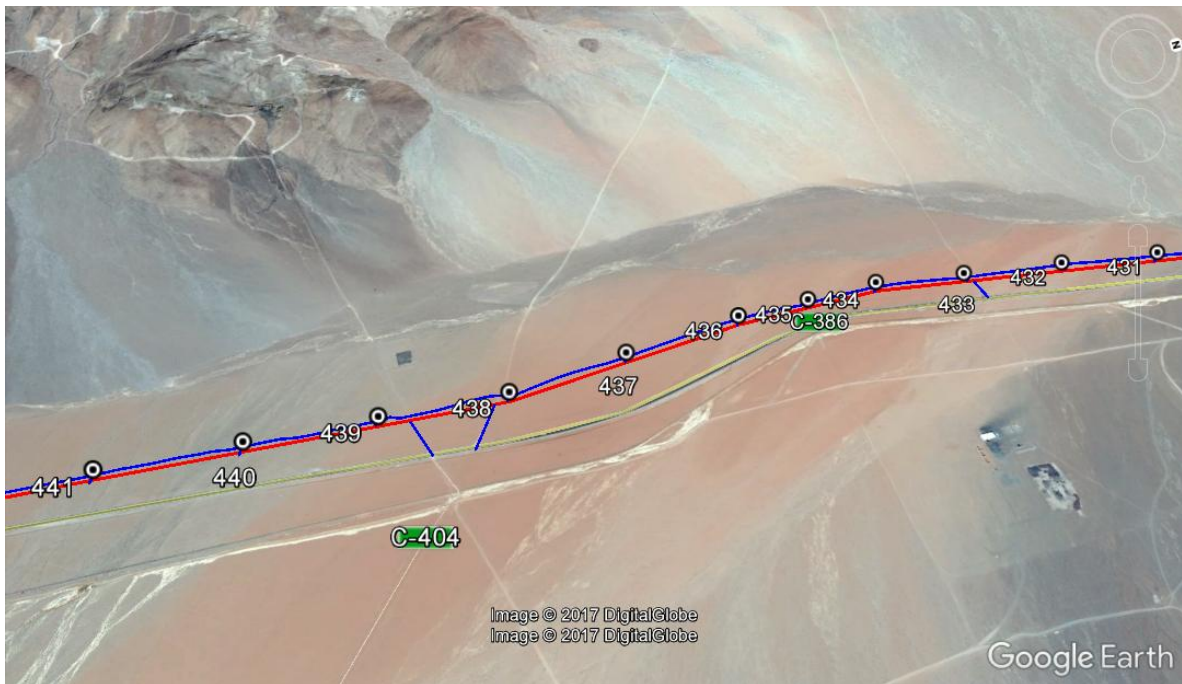
Figura 7: Tramo de la RCA N°114/2015 (Torres 431@441) donde se aplicó el escarpe tanto en el área de trabajo de la torre, el acceso y el troncal. En rojo el eje de la línea y en azul los accesos (peinetas) y el troncal.
