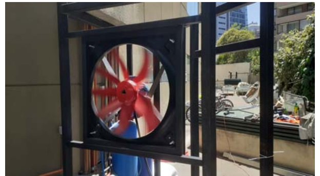
Figura N° 6 – Adición de pulverización y riego de enfriamiento, más extractores de calor
