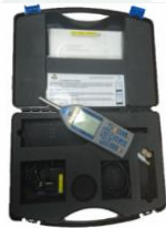
Sonómetro integrador Norsonic NOR131
