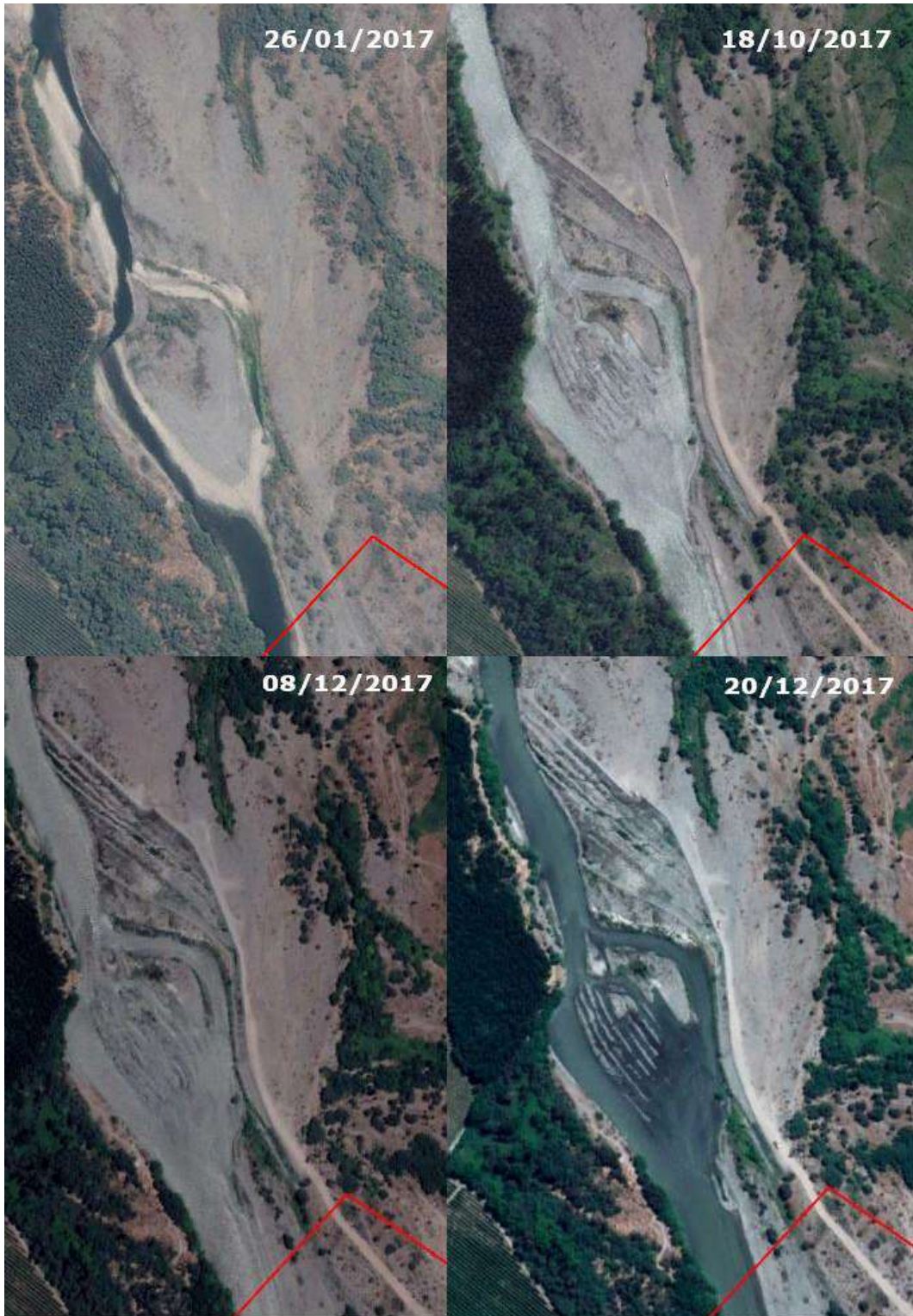
Imagen N° 6: Constatación de extracciones ejecutadas fuera del área autorizada por la RCA N° 207/2009 (en color rojo)
