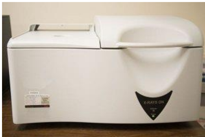
Figura 6. Espectrómetro de rayos x de dispersión de energía, EDXRF Thermo Scientific™ ARL™ QUANT'X
