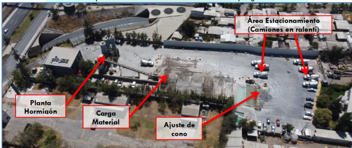
Ilustración 2. Emplazamiento Planta. Sector con áreas de mayor generación de ruido
