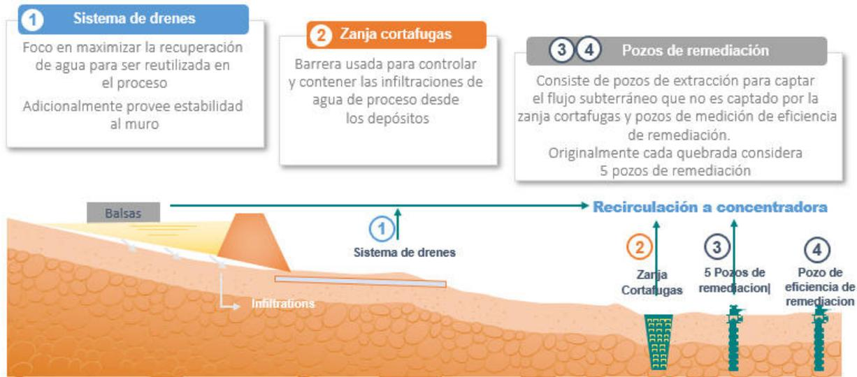
**Figura 1-4: Sistema de control de infiltraciones.**
