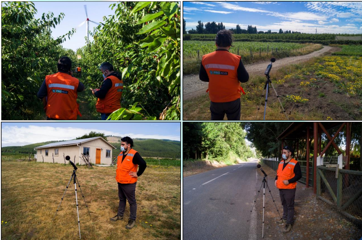
Ilustración 4. Registro fotográfico mediciones de ruido en puntos de calibración del modelo
