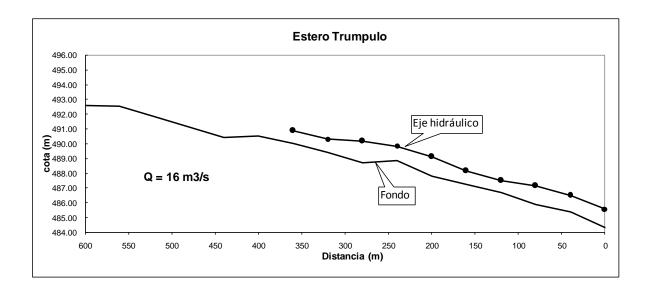
Aunque aún no se ha realizado un análisis granulométrico del fondo del estero, pero por lo observado en las paredes casi verticales del estero, de material cementado, con las velocidades resultantes lo más probable es que no se requiera defensas fluviales o se requiera un enrocado mínimo en el fondo, ya que para 2.5 m/s el gráfico 712-1 del Hidraulic Design Criteria del Corp of Engineers indica un enrocado de  $23 \text{ kg y } D_{50}=0.26 \text{ m}$ .
