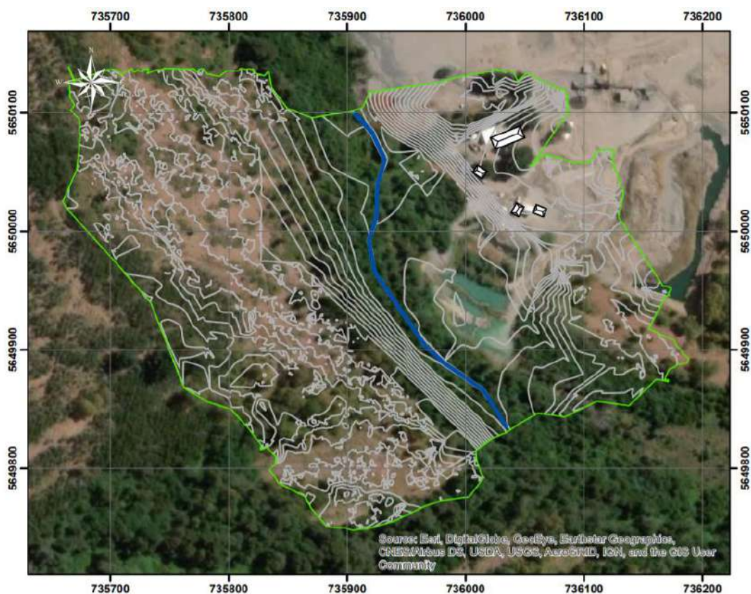
Figura 2. Extensión de levantamiento topográfico actualizado, curvas c/0,5 m
