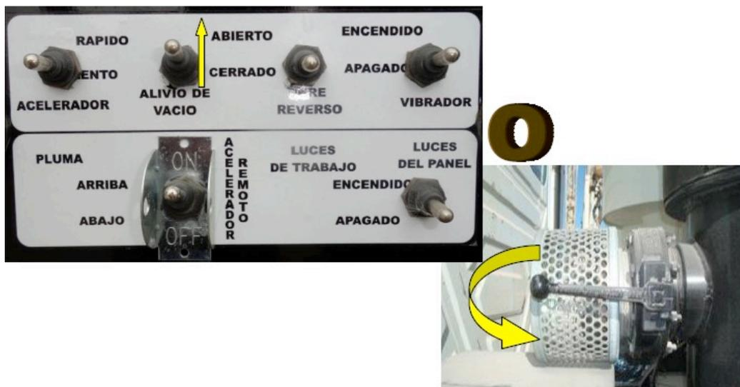
14. Termino Aspiración: Desconexión: Desacelerar equipo a ralentí, mediante switch acelerador.
