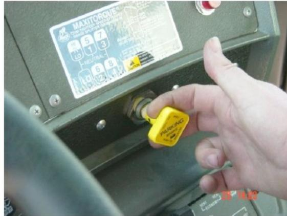
3. Inicio Conexión: Paradas de emergencia (Opcional): Verificar que estén desactivadas las paradas de emergencia, ya que, estando activadas no permitirán el funcionamiento del acelerador remoto.
