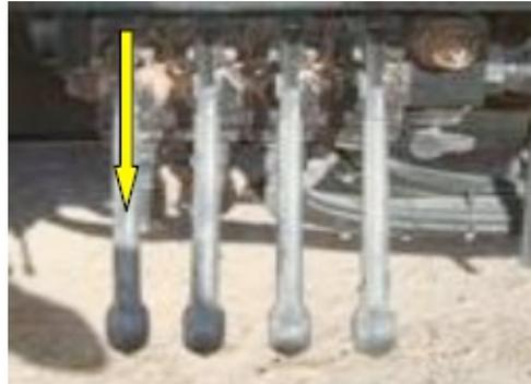
7. Descarga: Activación Vibrador: Mediante swich de pulso "vibrador", mantener accionado por intervalos de 10 segundos, para que se active vibrador que ayudará a remover el material de la tolva.
