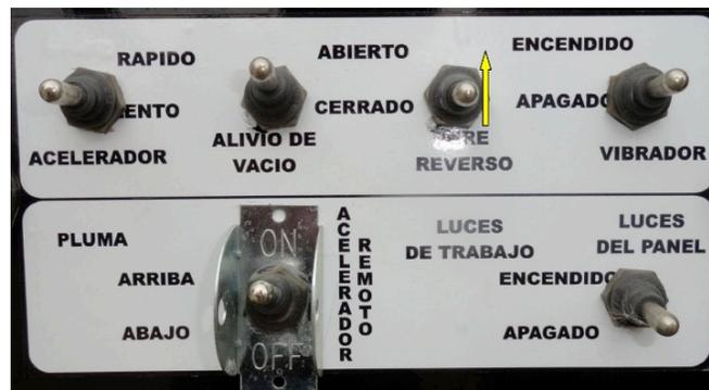
12. Inicio Conexión: Aceleración: Acelerar mediante switch acelerador a rango de 1.200-1.800 RPM, por ningún motivo superar las 2.000 y cerrar válvula de seguridad.
