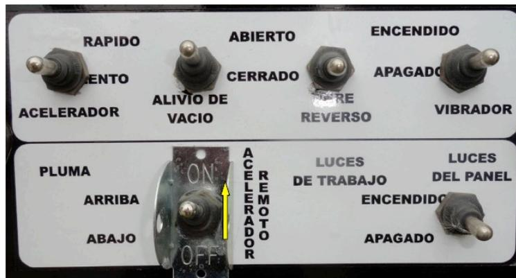
10. Inicio Conexión: Conexión Bomba de Vacío: Sin soltar embrague, mediante palanca "Bomba Vacío" conectar llevando a posición "Conectada". Soltar embrague lentamente. Equipo ya está generando vacío.
