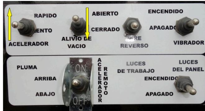
13. Desconexión: Válvula de seguridad: Abrir válvula de seguridad, por panel de control o por palanca.
