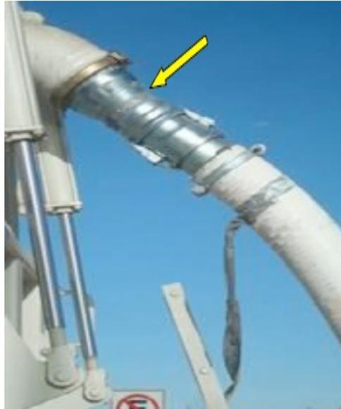
12. Inicio Conexión: Conectar Punta de aspiración: En la punta de aspiración, colocar el accesorio necesario para el tipo de trabajo, Lanza de 4", Carro para gravilla, carro para polvo. Colocar Tape, para evitar fugas en el caso de que no se pueda colocar una abrazadera.
