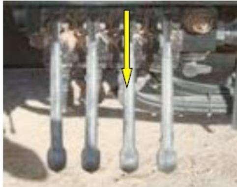
5. Descarga: Apertura de Portalón: Mediante la palanca "Compuerta Trasera " Tire-Abrir, para abrir el portalón.
