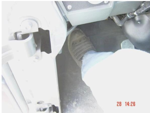
6. Inicio Conexión: Marcha atrás: Con el fin de frenar inercia de caja de cambios, colocar marcha atrás y posteriormente poner 9ª marcha o una menos del total de marchas, con selector GAMMA en alta.
