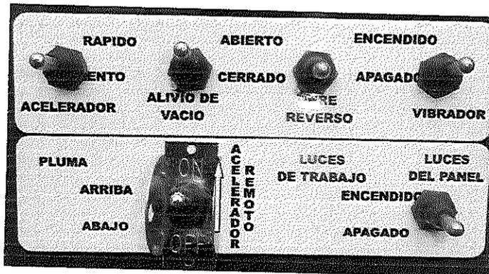
3. Inicio Conexión: Aceleración: Acelerar mediante switch acelerador a rango de 1.000 RPM.
