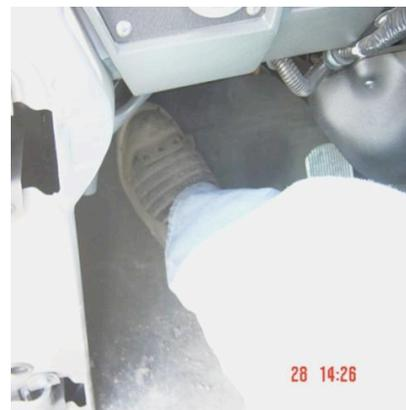
16. Desconexión: Desactivación de acelerador remoto: Desactivar switch de "acelerador remoto" a posición OFF. Apagar Sistema auto-limpieza filtro (aire reversa).
