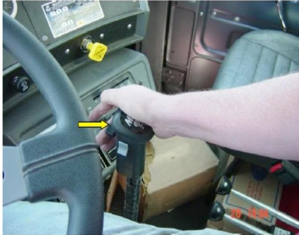
7. Inicio Conexión: Enganche Hidráulico: Sin sacar el pie del embrague, conectar la palanca de sistema hidráulico o "Eje trasero" a posición "Desenganchado". Suelte el embrague suavemente. El sistema hidráulico quedará operativo. Se prendera luz "Eje trasero desenganchado", en el tablero.
