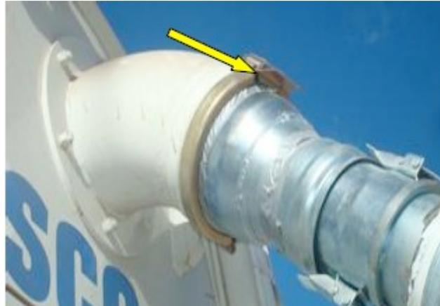
10. Inicio Conexión: Preparación de mangueras: Dependiendo de la distancia a la cual se desea aspirar, preparar las mangueras necesarias, colocando un acople macho y un acople hembra en cada uno de los extremos, asegurándolos con una abrazadera. Tener presente que para una óptima aspiración se debe llegar al punto de aspiración con el mayor diámetro de manguera (8" o 6") y realizar la reducción (4" o dos de 2,5") en la punta de aspiración para mejor maniobrabilidad de los operarios.
