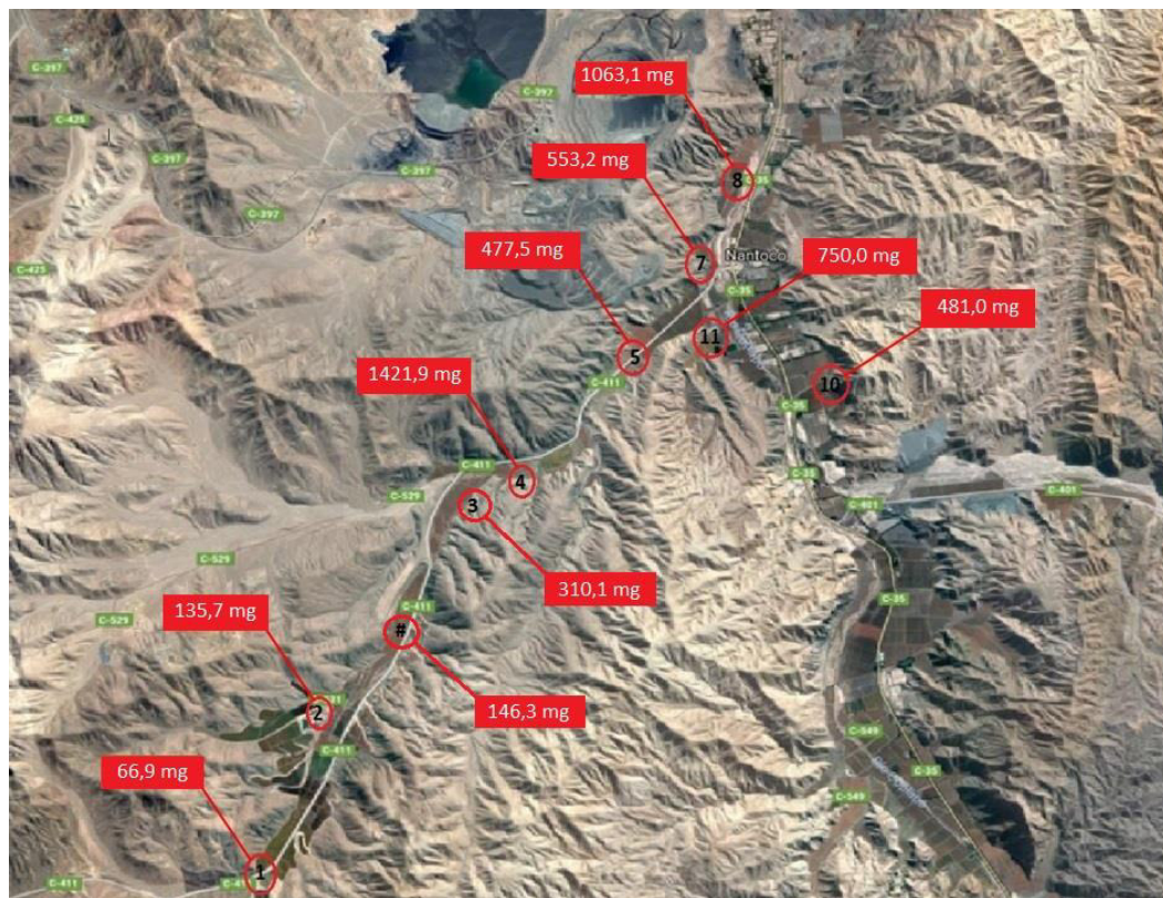
Figura 1. Ubicación de estaciones de monitoreo de MPS y cantidad total acumulada de polvo, entre septiembre 2017 y septiembre 2018.
